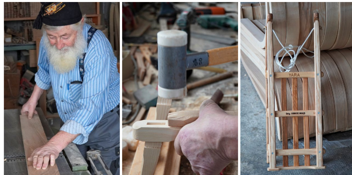
Ausmessen, zuschneiden, feilen, hobeln und, und, und: Für einen originalen Grindelwalder aus Eschen- & Kirschbaumholz rechnet Hans Burgener mit ungefähr sieben Stunden Arbeit. Kostenpunkt: 325 Franken.
